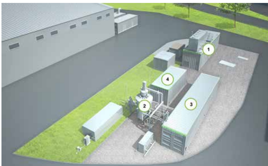
Demonstrationsanlage Power-to-Gas mit: 1) PEM Elektrolyseur (400 kW), 2) Biologische Methanisierung, Separater Druckbehälter, 3) Verfahrenstechnischer Container: Pumpen, Behälter, Gasanalytik, Temperiersystem, 4) Steuerungstechnischer Container: Steuerung, Mess- und Regeltechnik. (Bilder: Schmack Carbotech, Viessmann Group)
